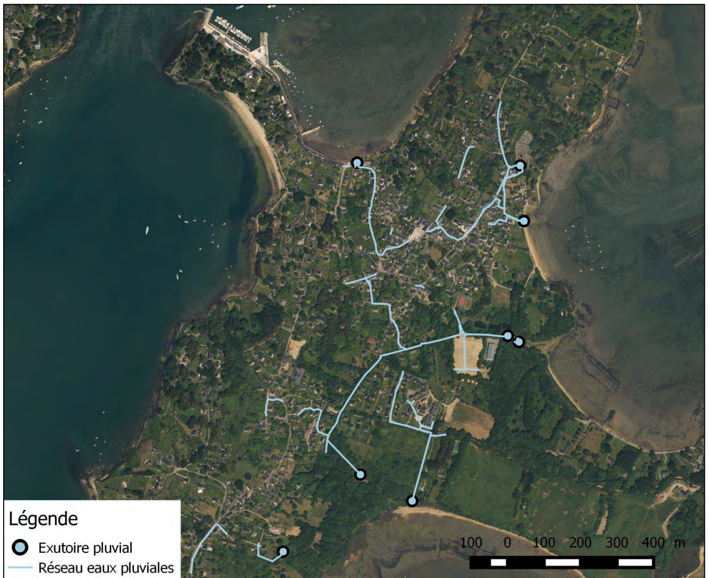
Figure 32 : réseau d'eaux pluviales et principaux exutoires de l'Ile aux Moines
