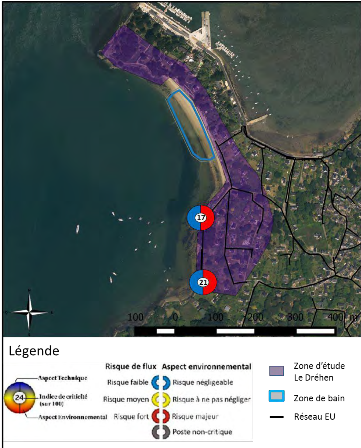
Figure 36 : Criticité des postes de relèvement de La Corniche et de Mane Rinville
