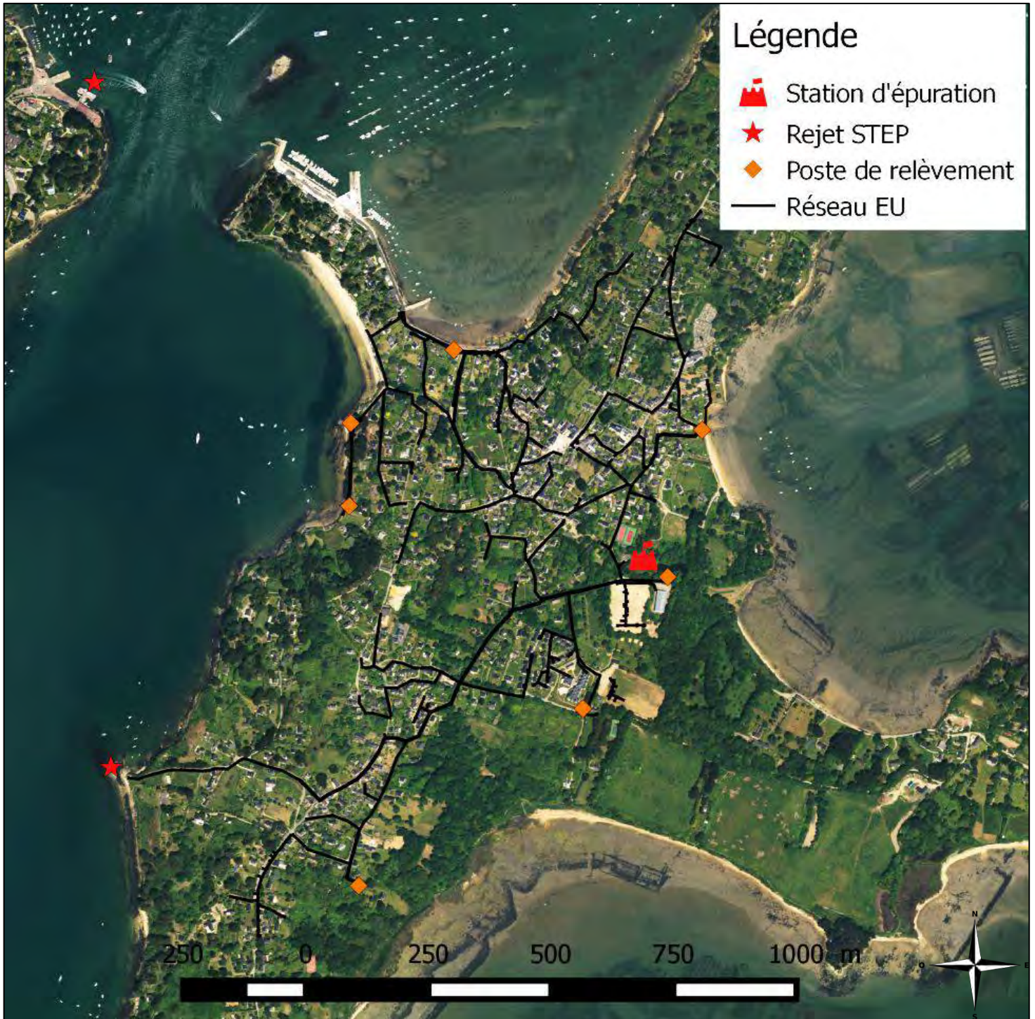
Figure 27 : système de collecte et de traitement des eaux usées de la commune de l'Ile aux Moines
